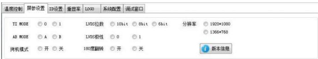
屏参设置：关于大屏拼接盒子 LVDS 信号输出的一些设定（方便点屏测试）和拷机模式的开
