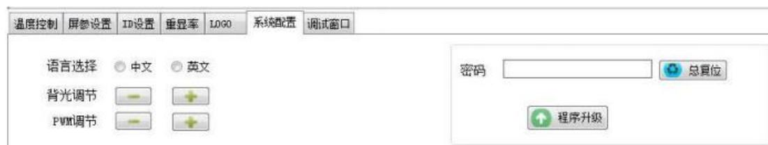
语言选择，包括中文和英文选择；背光控制模块，包括背光电压调节和 PWM 输出频率调节，以及机器总复位功能，密码为：cjfw
