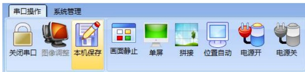
关闭串口：单击此按钮可关闭串口。关闭后，所有和通讯相关的功能均无效。
